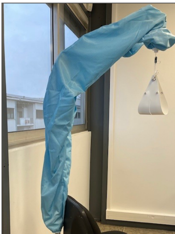
Figure 40. Jouer sur la position du nœud N pour le réglage de la hauteur et de la force des coudières. Si le réglage par le nœud N n'est pas suffisant, il est aussi possible de jouer sur la tension de l'élastique au niveau du tambour et de rejouer ensuite sur la position du nœud N.
