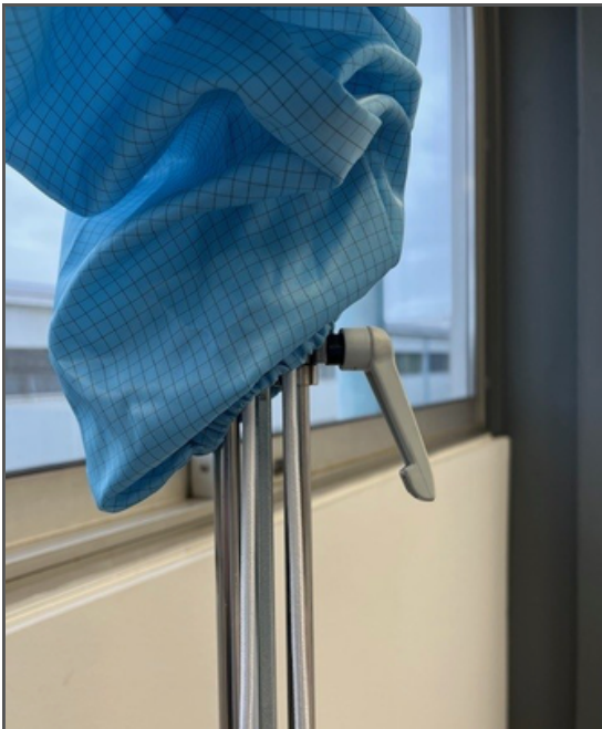
Figure 22. Passer en deux temps les manettes puis enfiler l'élastique de la housse dans la gorge de la platine.
