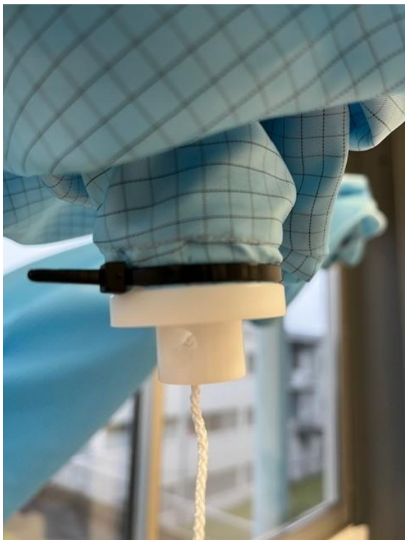
Figure 34 En option serrer la housse avec un collier rilsan sans abimer la housse...
