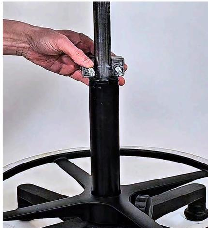
Image 7 : placer une mâchoire avec la plaque de recouvrement. Ne pas oublier deux rondelles.
