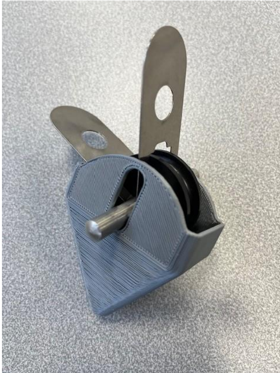
Figure 10 ... puis terminer d'emmancher l'axe long...
