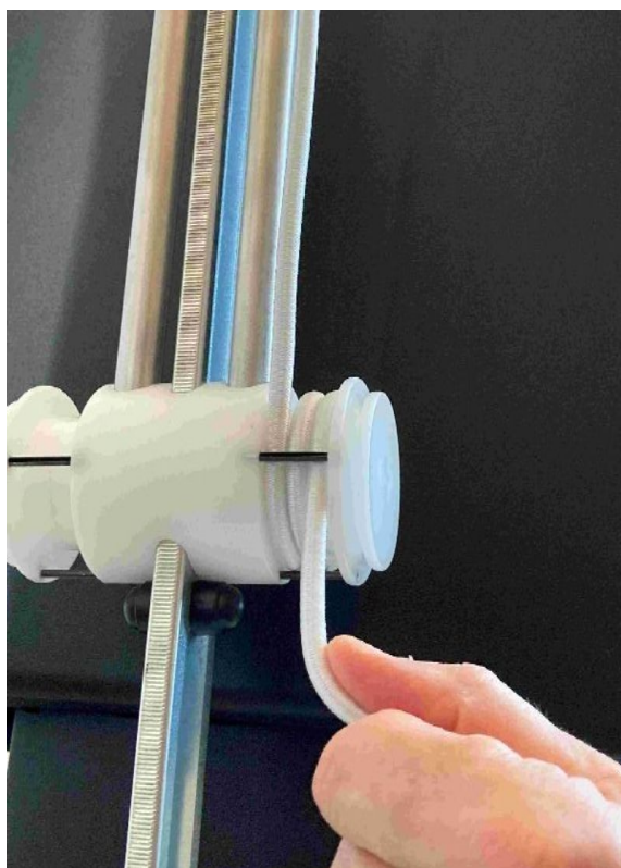
Image 31 : faites 2 tours complets (ne pas repasser une 3eme fois dans la goupille de dessous) puis...
