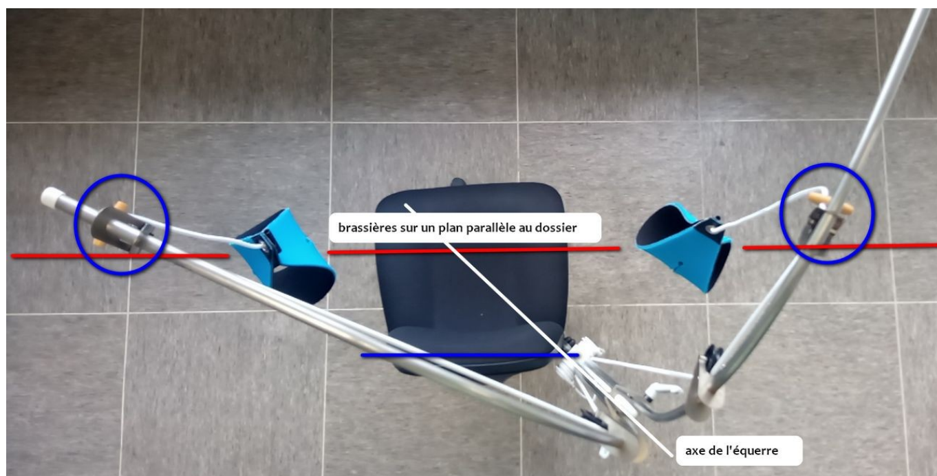
Image 11 : Dans ce cas, réglez la position des porte-poulies afin que les brassières arrivent à la verticale des coudes, dans un plan parallèle au dossier.
