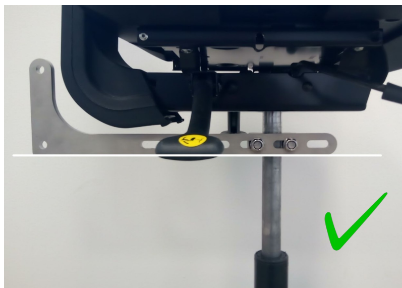
Image 7 : L'équerre doit laisser un espace suffisant en arrière du siège. Veiller à aligner horizontalement l'équerre. Serrer les écrous.
