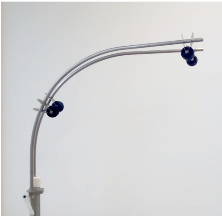
Image 22 : en pinçant les poulies, faites les glisser approximativement comme sur l'image.
