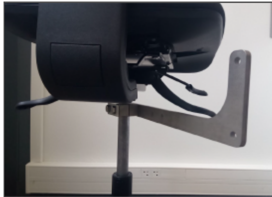
Image 10. Si la mise en place de l'équerre est gênée par un obstacle, la faire pivoter comme le montre l'image suivante.
