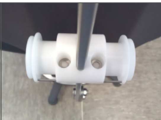
Image 16. placer les rondelles dans les deux trous en vérifiant qu'elles sont bien à plat.
