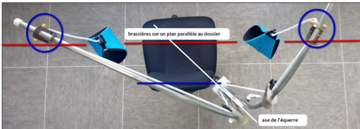
Image 11. Dans cette configuration, réglez la position des porte-poulies afin que les coudières arrivent à la verticale des coudes, dans un plan parallèle au dossier.
