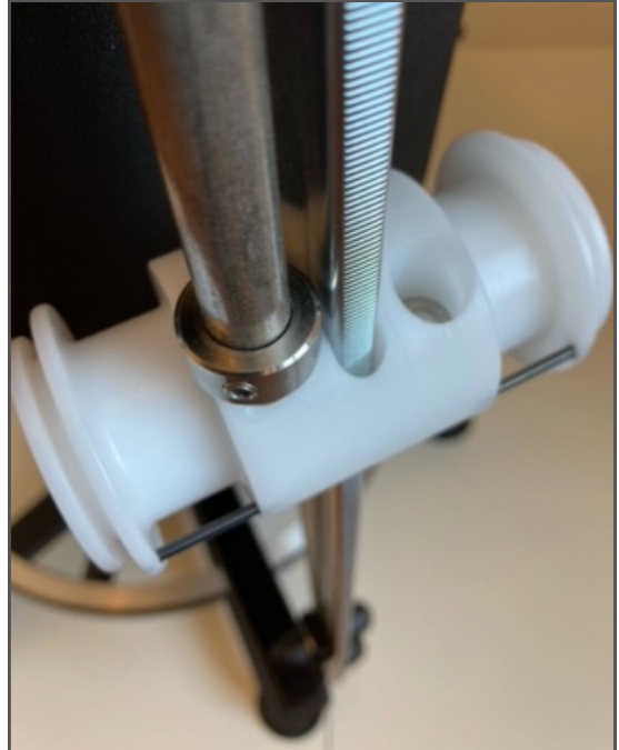
Image 19. ne pas serrer la bague pour le moment.
