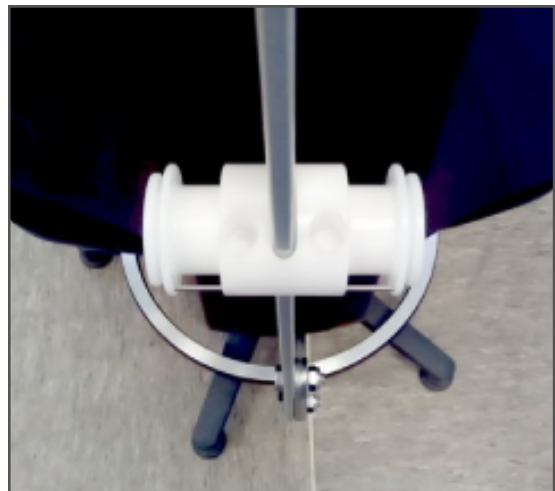
Image 15. Glisser le tambour, les deux trous vers l'arrière
