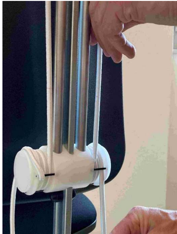
Bild 45 : Wenn Sie mehr Kraft wünschen, nehmen Sie das Gummi aus seiner Klemmfuge, schieben Sie das Gummi einige Zentimeter nach unten, legen Sie das Gummi wieder in die Fuge (Bild 46) und testen Sie erneut den Komfort. Wiederholen Sie den Vorgang, bis der Benutzerkomfort erreicht ist. Achten Sie beim Einstellen darauf, dass der Benutzer die Armschlaufen nicht nutzt.
