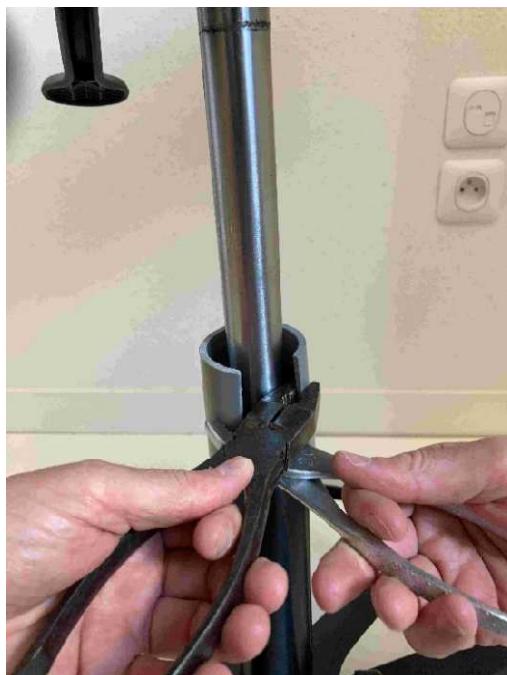
Bild 8 : ...die Hand (oder mit den Zangen) die Ringöffnung auf spreizen, um ihn auf...
