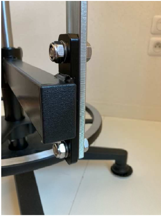
Bild 14 : Montieren Sie die Sitzstange mit Hilfe der beiden großen Bolzen.
