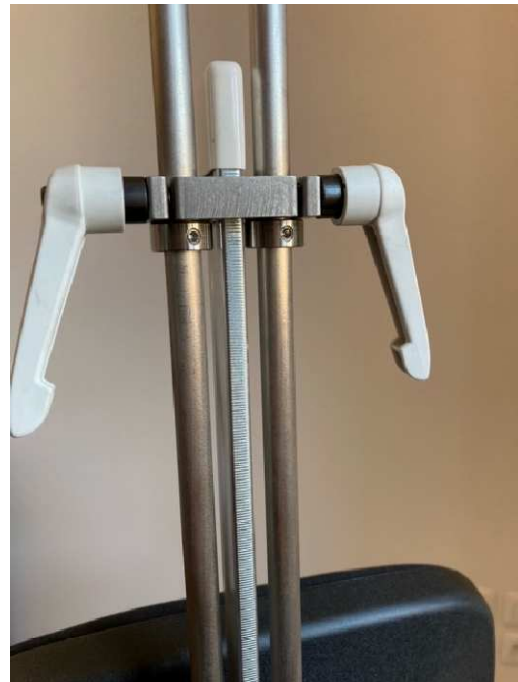
Bild 25 : Schieben Sie die Ringe bis zum Anschlag gegen die Halterung und ziehen Sie sie fest. Diese Sicherungsringe verhindern, dass die Bögen herausrutschen und aus den Löchern der Trommel fallen, falls unsachgemäß gehandhabt wird. Die Hebel sind drehbar. Sobald sie festgezogen sind, können sie durch Ziehen ausgerichtet werden.
