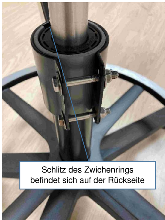
Bild 12 : Verwenden Sie die Bolzen, um die Deporthebel festzuziehen, bis er mäßig in seiner Rotation blockiert ist. Überprüfen Sie, ob der Sitz auf- und absteigen kann. Wenn der Sitz nicht mehr hochfährt, lockern Sie leicht die Bolzen.
