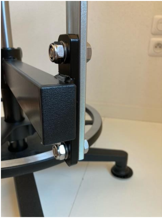
Image 14 : assembler la barre de serre-joint à l'aide des 2 gros boulons.
