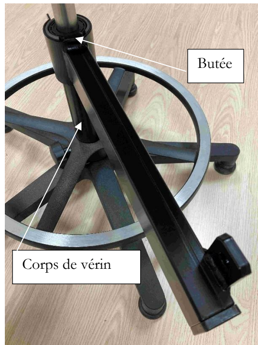
Image 11 : descendez l'interface jusqu'à ce que sa butée arrive en contact du corps du vérin. La fente de la bague plastique et la fente de l'interface sont opposées.
