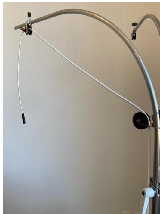
Image 33 : passer les élastiques dans les poulies, les boutons-tonneaux en butée contre les poulies.
