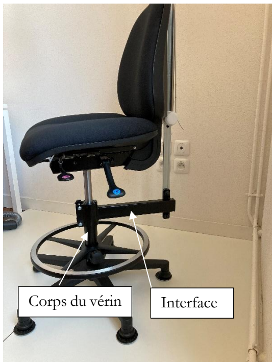
Image 6 : La première étape est d'installer l'interface sur le corps de vérin. Pour cela ...
