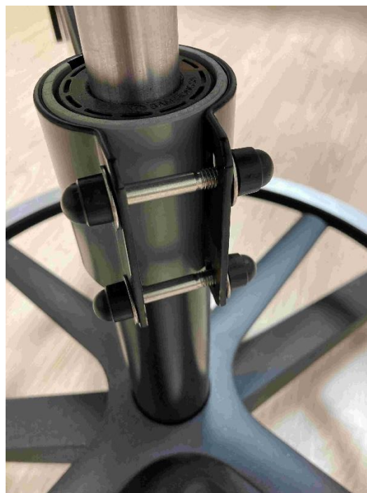
Image 13 : placer les caches-écrous.
