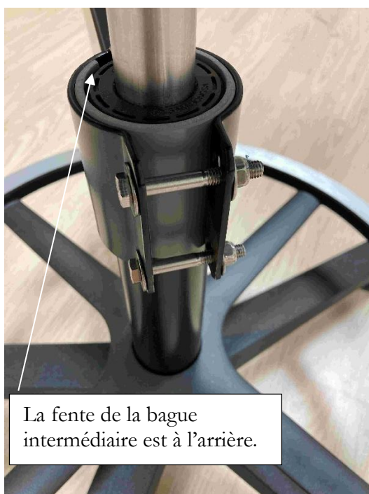
Image 12 : A l'aide des boulons, serrer l'interface jusqu'à ce que l'interface soit modérément bloqué en rotation. Vérifier que le siège peut monter et descendre. Si le siège ne remonte plus, desserrer légèrement les boulons.
