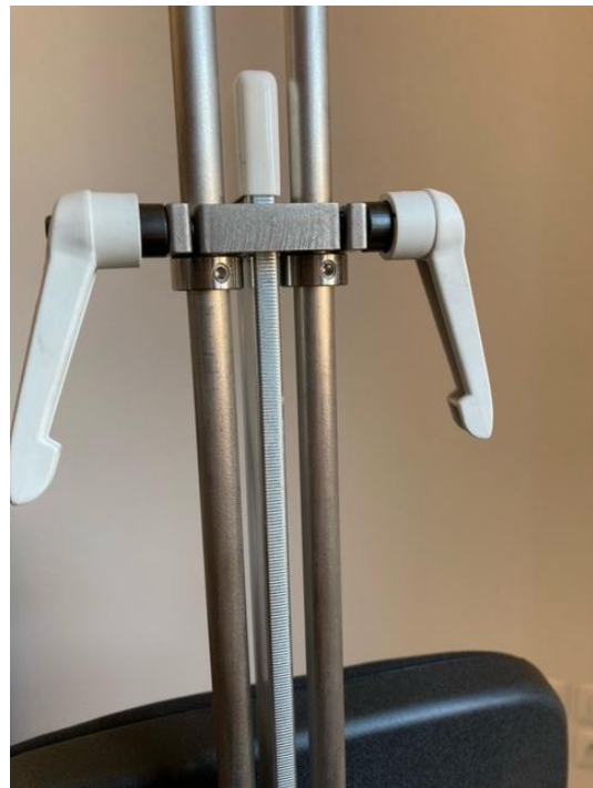
Image 25 : remonter les bagues jusqu'en butée contre la bride et les serrer. Ces bagues de sécurité évitent aux arcs de remonter et de sortir des trous du tambour en cas de mauvaise manipulation. Les manettes sont indexables. Une fois bloquées il est possible de les orienter en tirant dessus.
