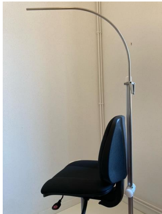
Image 21 : glisser un arc dans la bride jusque dans le trou du tambour tout en passant une bague comme sur l'image 22. L'arc doit reposer au fond du trou. Serrer légèrement la manette pour éviter que l'arc ne tourne dans tous les sens.
