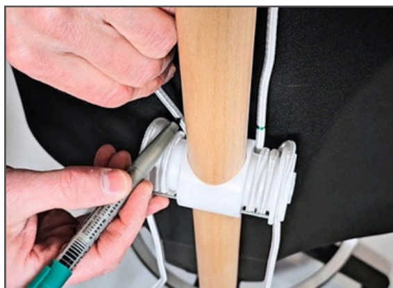
Image 46. Une fois la force réglée, tracer au feutre une marque circulaire sur les élastiques. Il peut y avoir autant de marques colorées que d'utilisateur.
