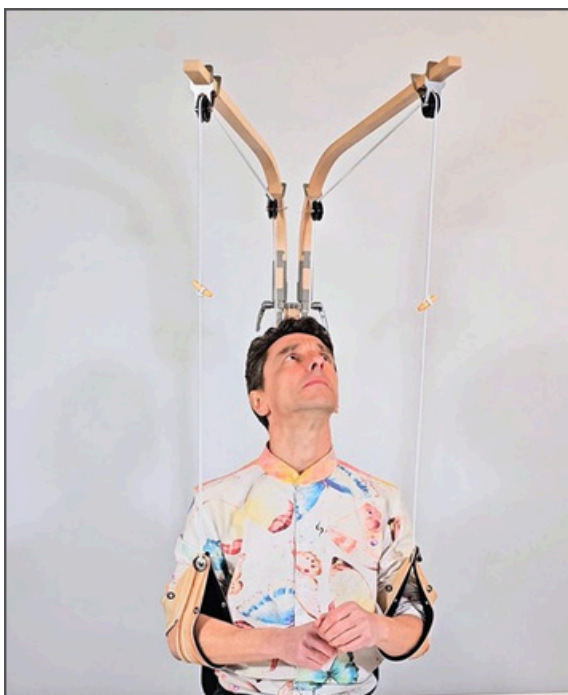
Image 45. Tester la force des élastiques à la recherche de votre confort. Si besoin procéder à un nouveau réglage. IMPORTANT : au repos dans les coudières, les bras ne doivent pas se retrouver au-dessus du niveau de travail. Jouer avec la force des élastiques pour trouver votre confort. La force à droite et à gauche doit être approximativement identique.
