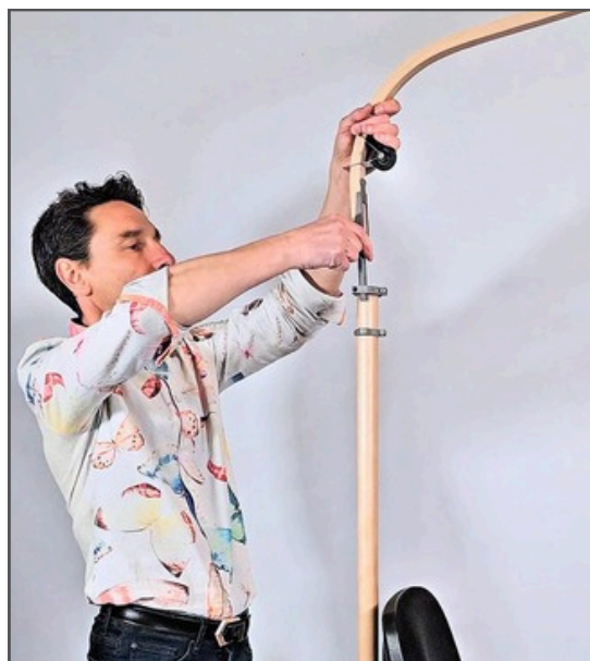
Image 20... puis insérer l'ensemble dans les paliers ...
